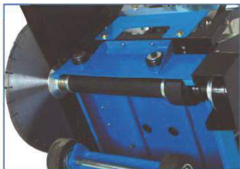
Wałek napędowy odporny na pył
