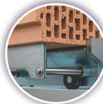
Dodatkowa możliwość poszerzenia stołu pozwala na łatwą pracę z większymi elementami
