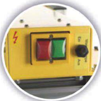
Dodatkowy wyłącznik pompy wody podczas pracy na sucho
